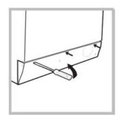
1. 用螺丝刀取下洗 衣烘干机前面下部 的盖板(*如图所* 示);
