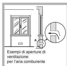
Il sistema può essere realizzato prelevando direttamente l'aria dall'esterno dell'edificio tramite un condotto di almeno  $100 \text{ cm}^2$  di sezione utile e tale che non possa essere accidentalmente ostruito.
