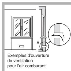
Le système peut être réalisé en prélevant l'air directement de l'extérieur du bâtiment au moyen d'un conduit d'au moins  $100 \text{ cm}^2$  de section utile qui ne risque pas d'être bouché accidentellement.
