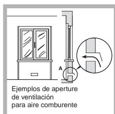
El sistema puede tomar aire del exterior del edificio a través de un conducto de  $100 \text{ cm}^2$ , como mínimo, de sección útil de modo que no pueda ser obstruido accidentalmente.
