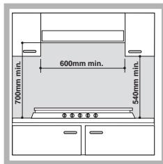
En cas d'installation de la table de cuisson sous un élément haut, ce dernier devra être monté à au moins 700 mm de distance du plan (voir figure).
