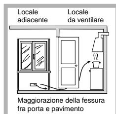
Ovvero, in maniera indiretta da locali adiacenti, dotati di un condotto di ventilazione con l'esterno come sopra descritto, e che non siano parti comuni dell'immobile, o ambienti con pericolo di incendio, o camere da letto.
