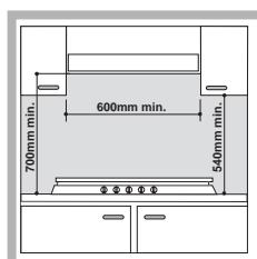
Siempre que la encimera se instale debajo de un armario de pared, éste último deberá mantener una distancia mínima de la superficie de trabajo de 700 mm. (ver la figura).
